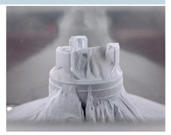
2 Der neue Radträger für das vollelektrische Rennauto nach seiner Fertigstellung im 3D-Drucker. Nun kommt es darauf an, mit einem geeigneten Werkzeug die anspruchsvolle Nachbearbeitung zu realisieren © Ceratizit
